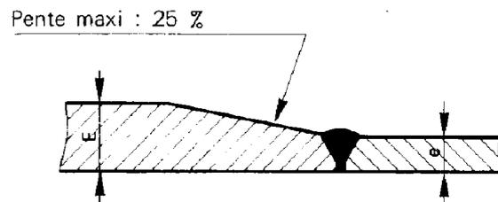
**3 - Si des éléments d'une épaisseur différente doivent être soudés, réduire la plus forte en biseau.**
