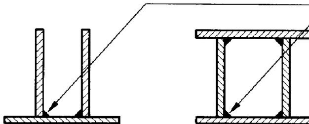
**5 - Veiller aux soudures inaccessibles ou impossibles à réaliser.**
